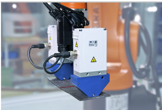
Préhenseurs à aiguilles électriques SNGi-AE lors de la manipulation de textiles composites
